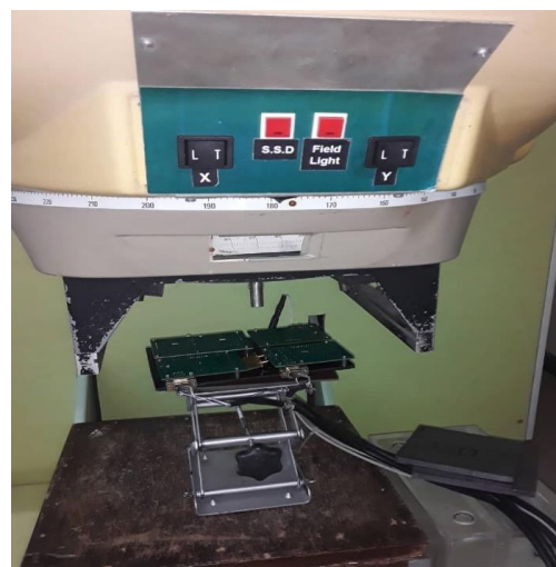
شکل ۵- پیکربندی پرتودهی نمونه‌های سری دوم.
