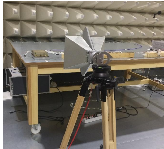
شکل ۱۲ - چیدمان آزمون RS در آزمایشگاه.
