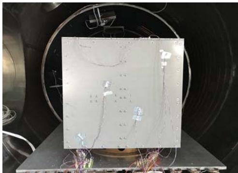
شکل ۷- مدل حرارتی ماهواره در محفظه خلأ پژوهشگاه فضایی ایران
