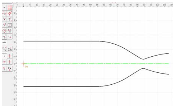
شکل ۱۳- محفظه‌ی رسم شده توسط RPA (تمام اندازه‌ها بر حسب میلی‌متر)
