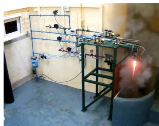
شکل ۳۰- تست گرم میکروموتور [۹]
