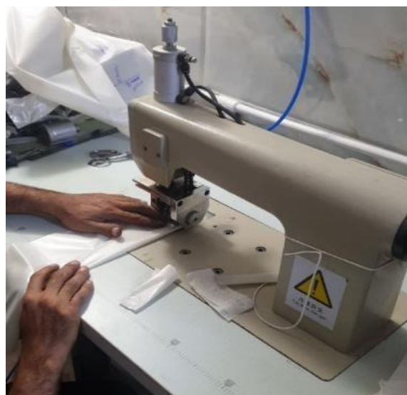
شکل ۵- دستگاه دوخت اولتراسونیک مورد استفاده.
