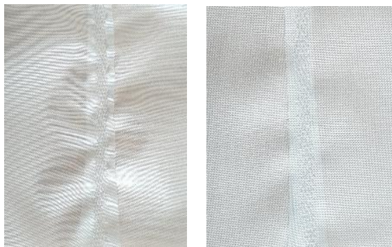
شکل ۶- نمونه‌های اتصال توسط تجهیز جوشکاری فرکانس بالا با هد نقطه‌ای توسط تجهیز شرکت آتیه‌سازان فرهود.
