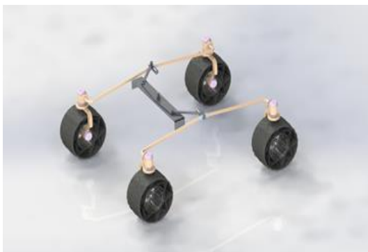
شکل ۸- زیر سیستم چرخ و تعلیق در کاوشگر آرمیتا [۱۳].
