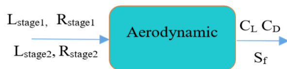
شکل ۶- دیاگرام ورودی و خروجی مدل زیرسیستم آیرودینامیک.
