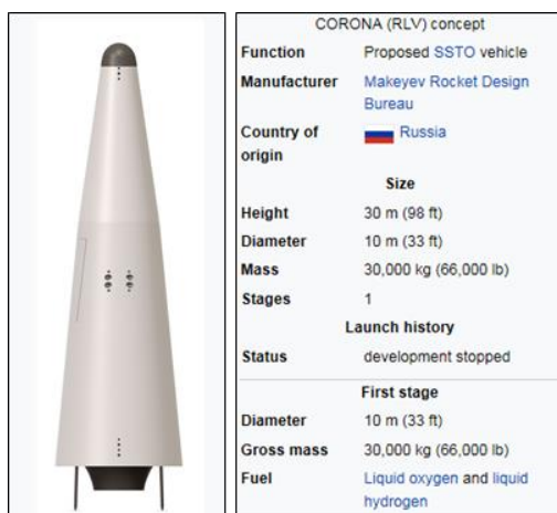
شکل ۱- نما و مشخصاتی از یکی از ساده‌ترین طرح‌ها برای SSTO، کرونا.
